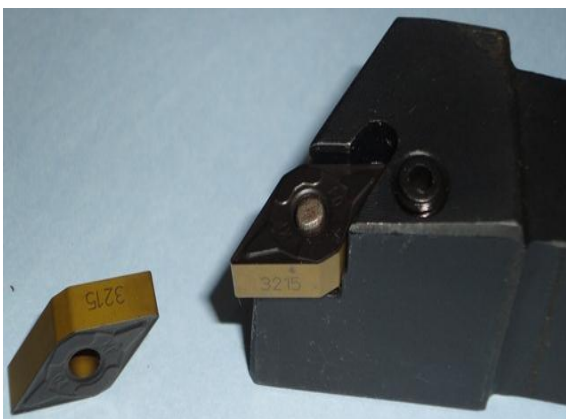
Figure 3: SANDVIK: DNMG 3215 Tool (K 15 – K 35 )
